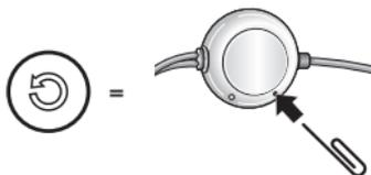
Вставьте скрепку в микроотверстие и слегка надавите на кнопку перезагрузки. Гарнитура автоматически выключится и произойдет перезагрузка системы.
